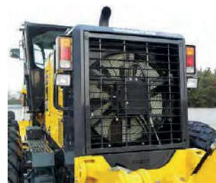
Ventilador de enfriamiento de accionamiento hidráulico
